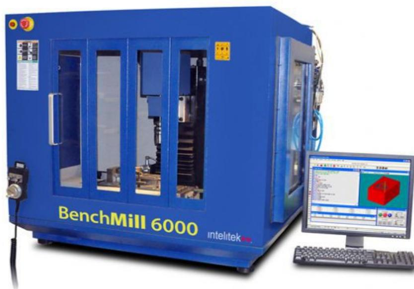
*Centro di Lavoro con programmazione Numerica Computerizzata progettato al fine di rendere possibile sia un chiaro e semplice apprendimento e sia un altrettanto facile metodo di insegnamento dei Sistemi di Produzione a CNC e FMS.*
